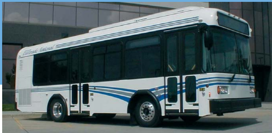
Figura 8.4. Autobús equipado con celdas de combustible poliméricas. En este tipo de aplicaciones se sustituye el motor térmico por una celda de combustible que utiliza hidrógeno gaseoso como energía química primaria para producir electricidad.
