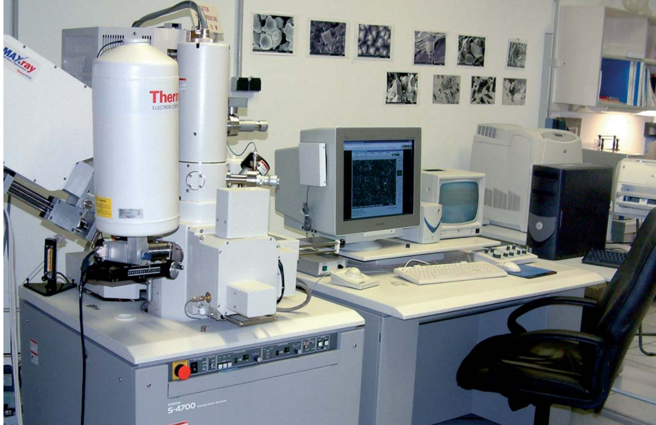
Microscopio Electrónico de Emisión de Campo utilizado en Investigación en Ciencia de Materiales. Instituto de Cerámica y Vidrio. CSIC.
