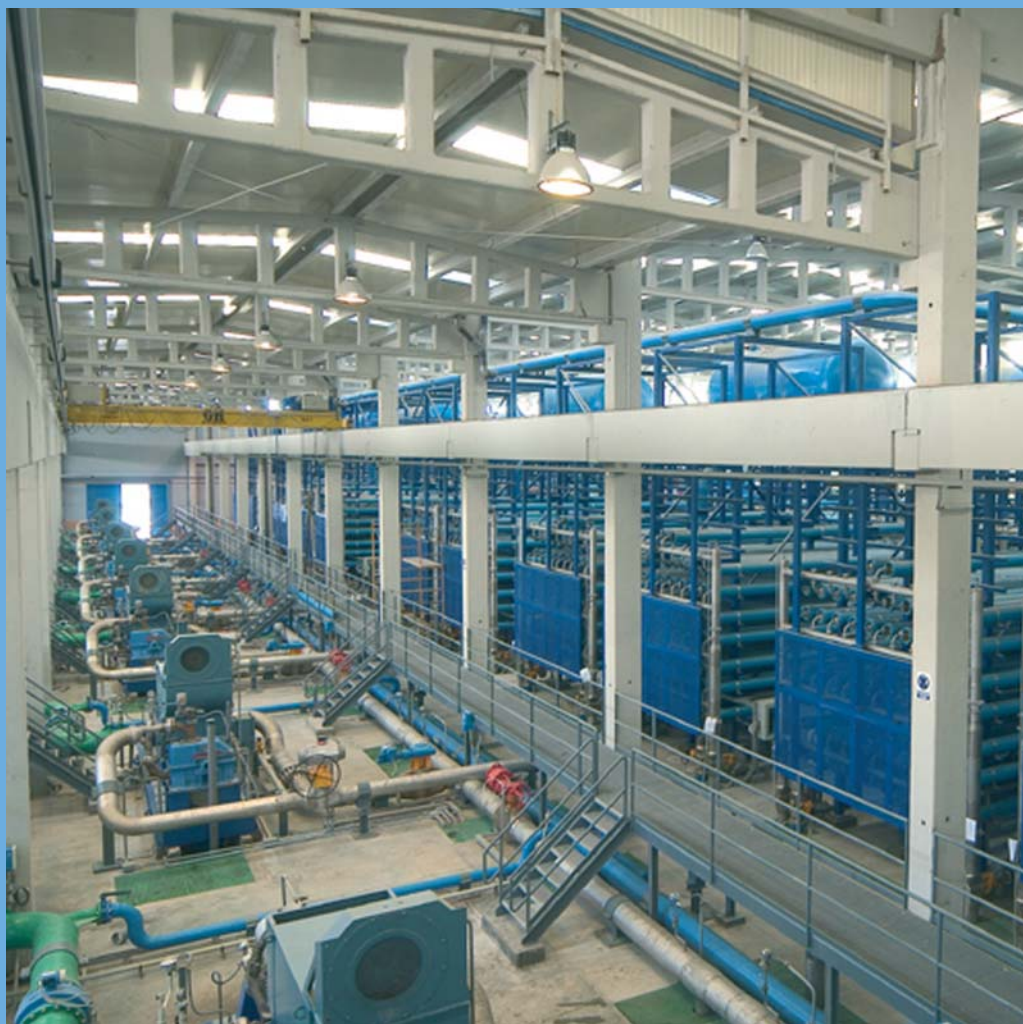
Figura 3.3. Planta desaladora de Carboneras (Almería), capaz de producir 120.000 m 3 /día de agua dulce. A la derecha, pueden verse cientos de módulos que contienen las membranas enrolladas en espiral.
