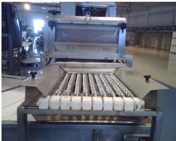
Fig. 7.6. Tubos cilíndricos para desbisado do mexillón
