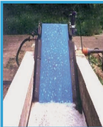
FIGURA 3.13. Filtro de banda.
