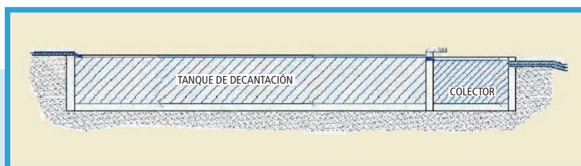
FIGURA 1.98. Sistema de decantación de residuos (Global Aquafish).
