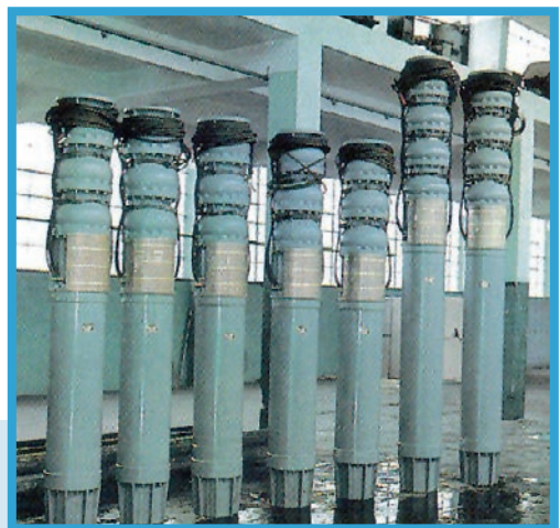
FIGURA 1.52. Bombas sumergibles.
