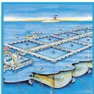
FIGURA 9.24. Esquema de las instalaciones Marine Construction AS.
