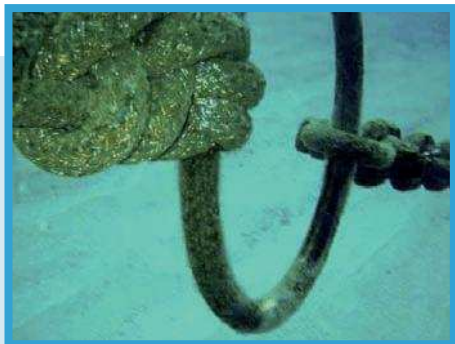
FIGURA 12.57. Unión cadena a estacha con anilla (Besmar).
