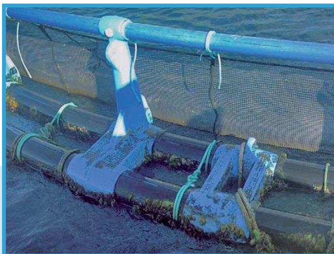
FIGURA 3.4. Estructura de flotación y sustentación.
