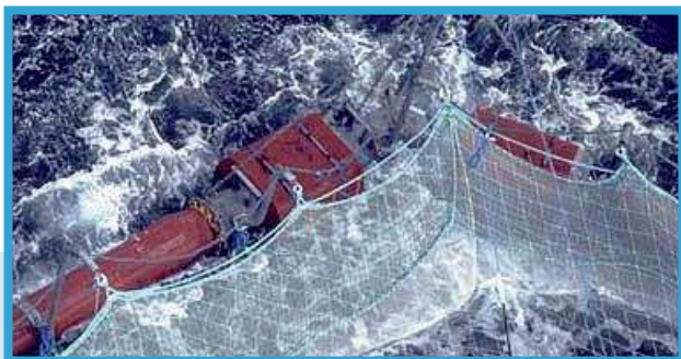
FIGURA 9.11. Detalle unión jaulas DUNLOP.
