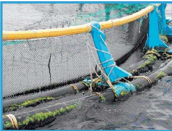
FIGURA 14.4. Daños en soporte (Global Aquafish).
