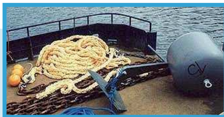
FIGURA 12.35. Elementos del sistema de fondeo.
