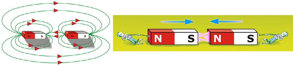
**Imagen 11.** Ilustración del comportamiento de las líneas de fuerza cuando acercamos dos imanes por polos opuestos e ilustración de la fuerza de atracción resultante.
