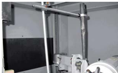
Figura 4. Tubo de órgano estudiado de forma no destructiva mediante difracción de rayos X en el ICMS. Dispositivo experimental.
