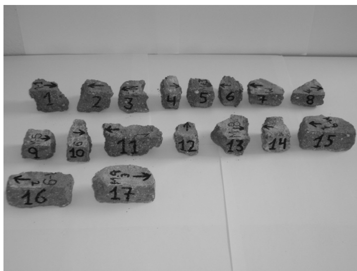
Figura 7. Ensayos de aplicación de productos consolidantes sobre ladrillo macizo. Bóvedas de sótano de la Casa de la Panadería en la Plaza Mayor de Madrid.
