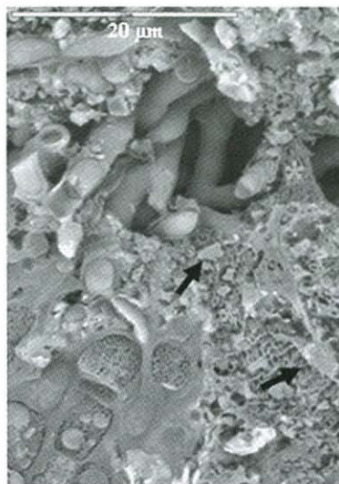
Figura 13. Imagen de LTSEM de un talo líquénico colonizando dolomías de la Iglesia de la Veracruz. Las flechas indican los fragmentos minerales inmersos en la red de EPS (asteriscos).
