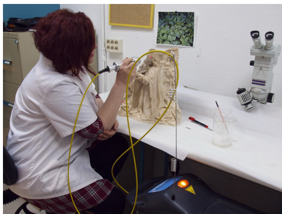
Figura 2. Aplicación de láser a la limpieza de un relieve de alabastro © A. Plaza.
