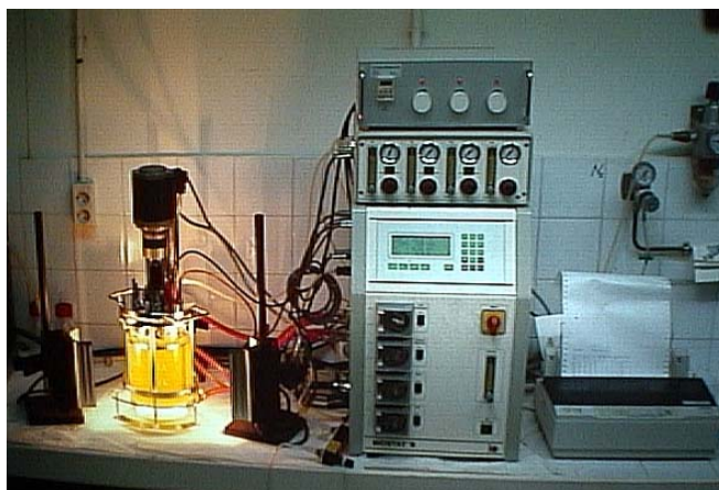
Fotobioreactor para la extracción de pigmentos en microalgas marina. Foto: L. M. Lubián.
