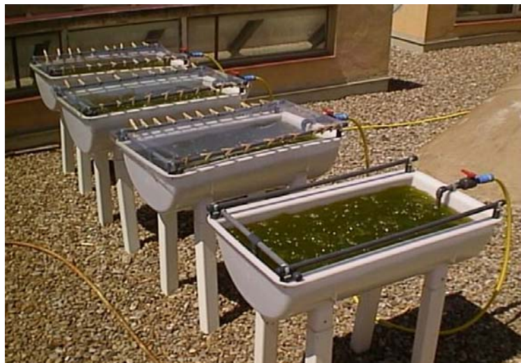
Ensayo sobre el efecto de la radiación UV sobre cultivos de varias especies de microalgas marinas. Azotea del ICMAN. Foto: L. M. Lubián.
