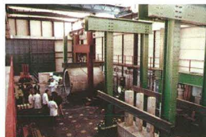
ENSAYO DE TRES ARISTAS SOBRE TUBO DE HORMIGÓN ARMADO. INSTITUTO EDUARDO TORROJA.
