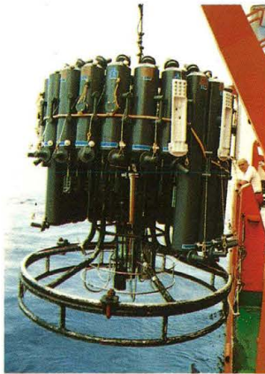
SONDA DE TEMPERATURA, SALINIDAD Y PROFUNDIDAD. INSTITUTO DE CIENCIAS DEL MAR.
