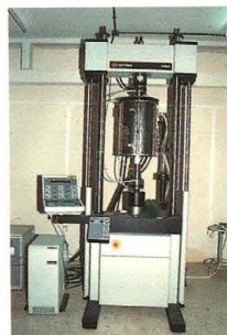
MÁQUINA UNIVERSAL DE ENSAYOS MECÁNICOS DE ALTA TEMPERATURA. INSTITUTO DE CERÁMICA Y VIDRIO, MADRID.
