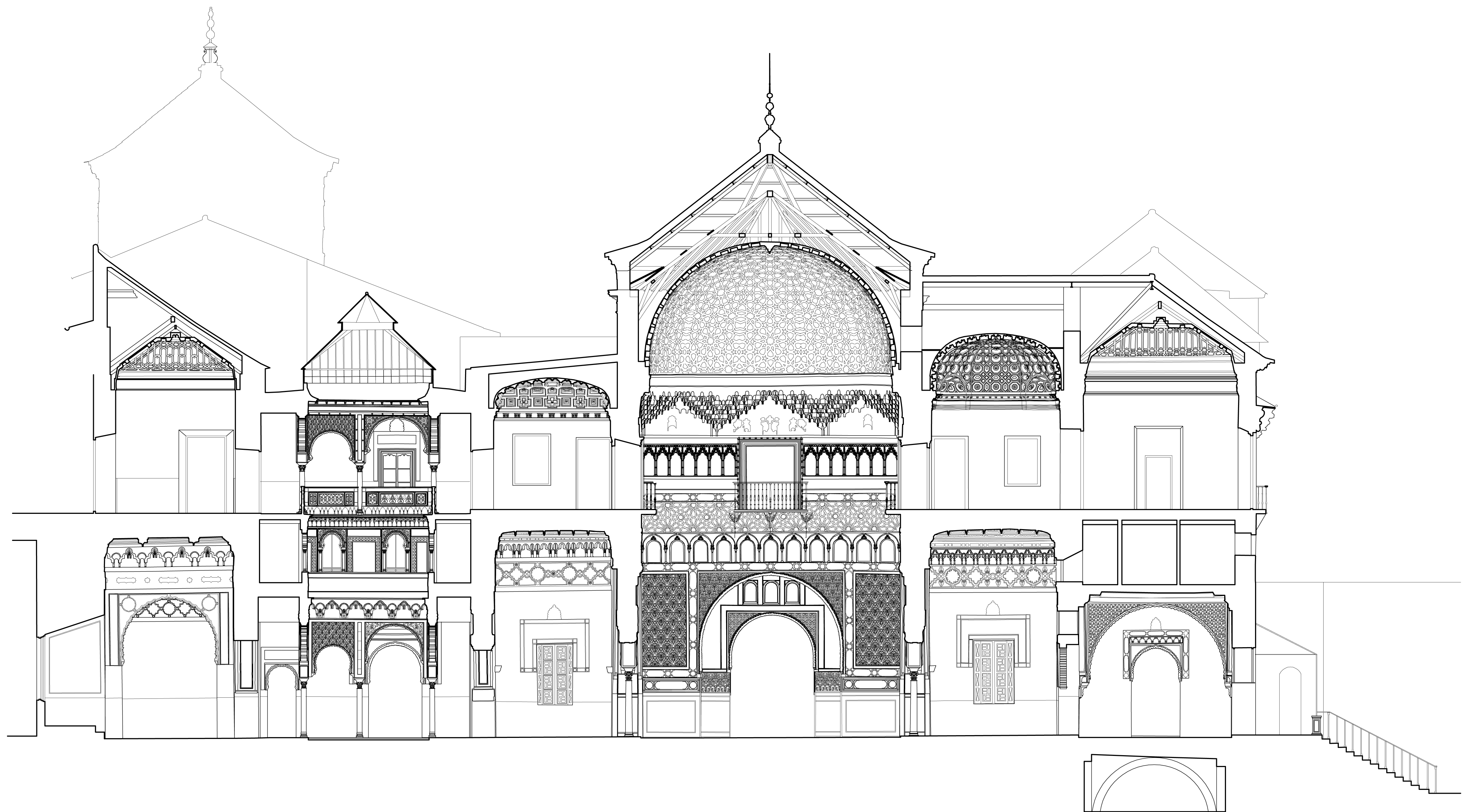
0 5 10 m ALCAZAR DE SEVILLA. PALACIO DEL REY D. PEDRO. SECCION TRANSVERSAL HACIA EL ESTE. ESCUELA DE ESTUDIOS ARABES, C.S.I.C. A.ALMAGRO/arq. I.ZUÑIGA/arq.tec.
