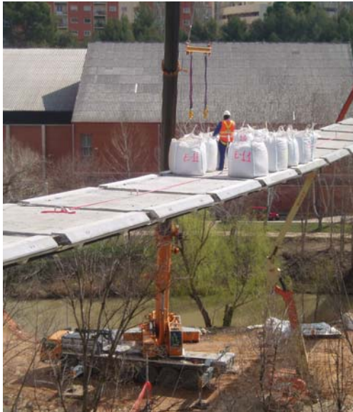
Figura 9. Fase de carga de la pasarela
