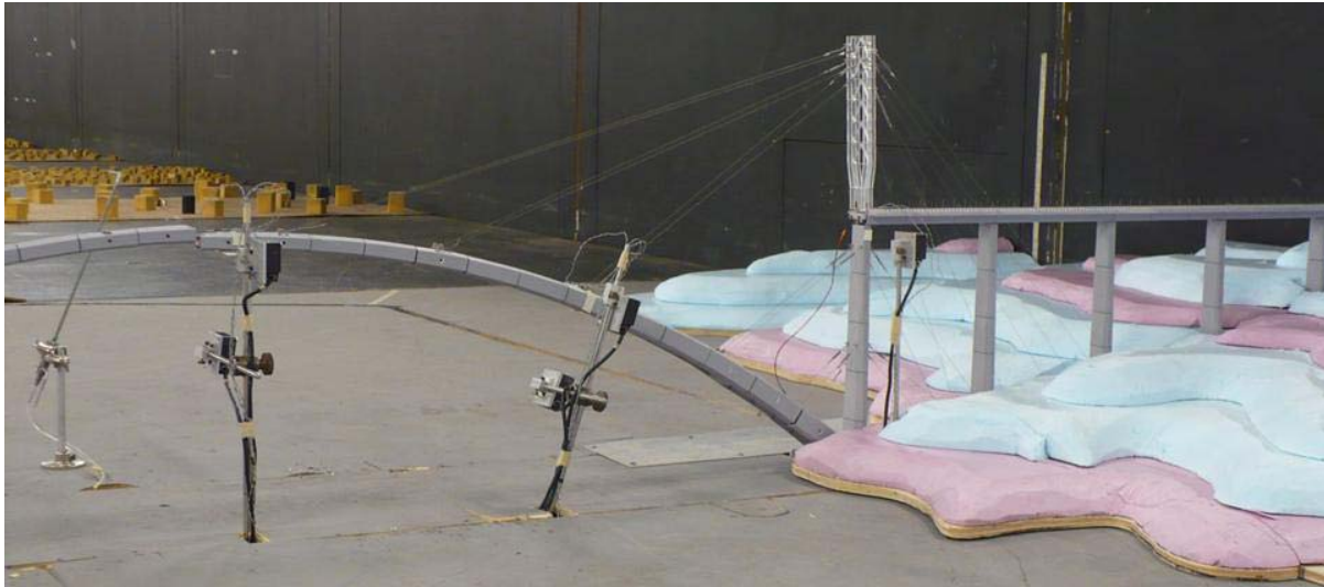
Figura 4: Modelo aeroelástico completo ensayado en fase de construcción con torre de atirantamiento para vientos normales al eje del tablero.
