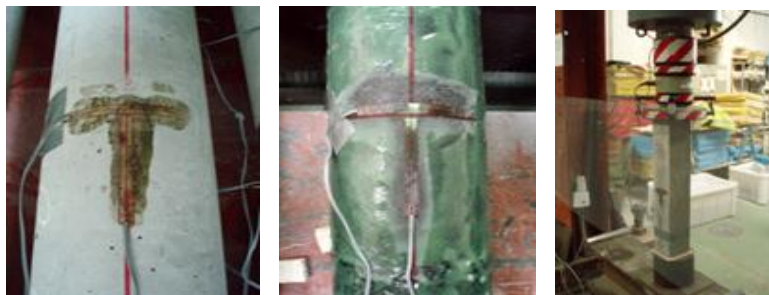
Figura nº 3. Instrumentalización de probetas
