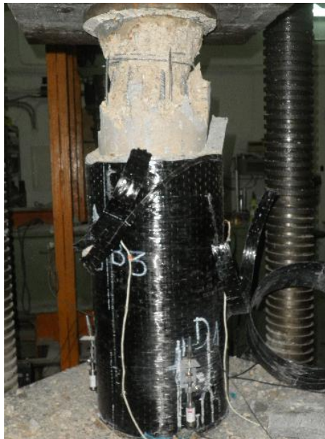
Figura 6.- Rotura típica del pilar
