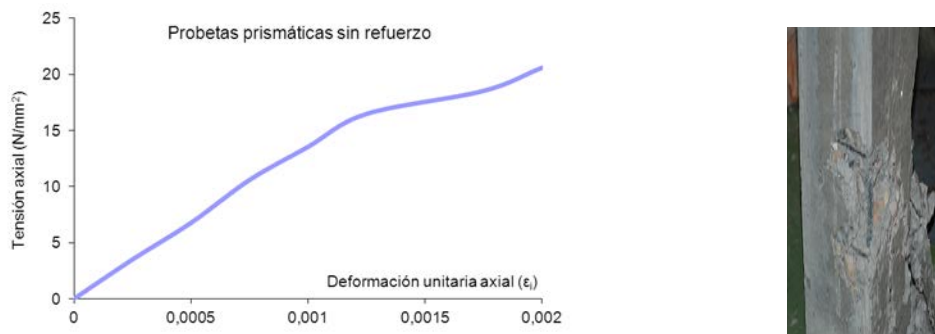
Figura nº 6. Gráfica tensión-deformación de probetas prismáticas sin refuerzo.
