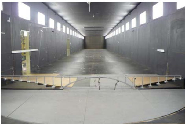
(A) Modelo aerolástico completo en flujo de baja turbulencia
