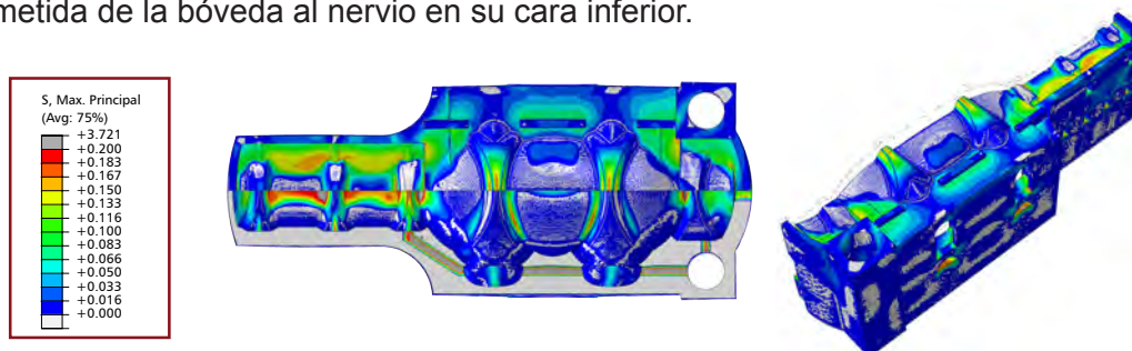
Fig.7. Mapa de Tensiones Principales Máximas de Tracción (MPa).
