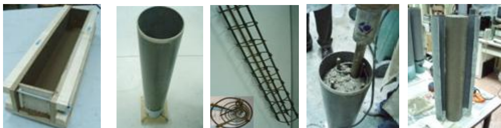
Figura nº1. Proceso constructivo de probetas-pilar.
