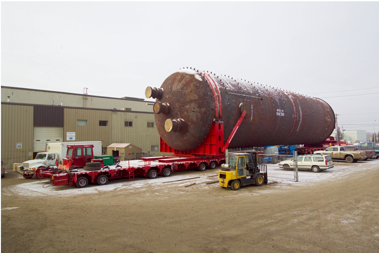
Figura 2. Transporte especial para cámara de coque
