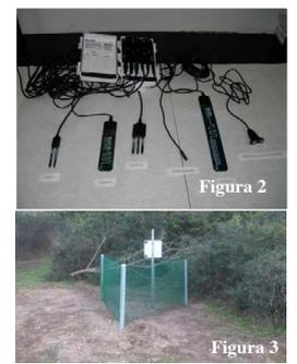
Figura 1. Instalación de los sensores. Figura 2. Sensores FDR. Figura 3. Imagen de una instalación ya equipada y protegida.
