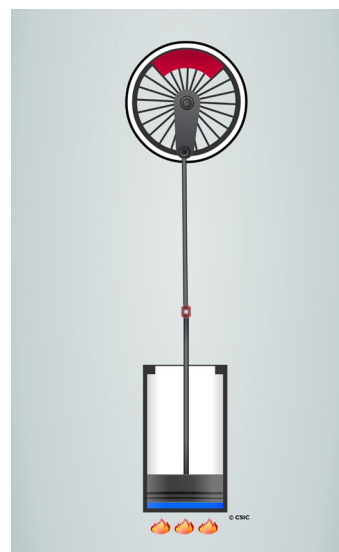
Imagen 17. Nuestra recreación de la máquina de Papin adaptada a un eje.
