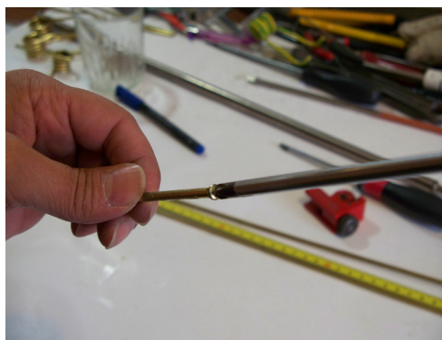
Imagen 6. Relleno del tubo con arena fina.
