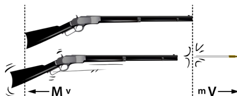
Imagen 21. Ilustración del principio de conservación de la cantidad de movimiento en una escopeta.
