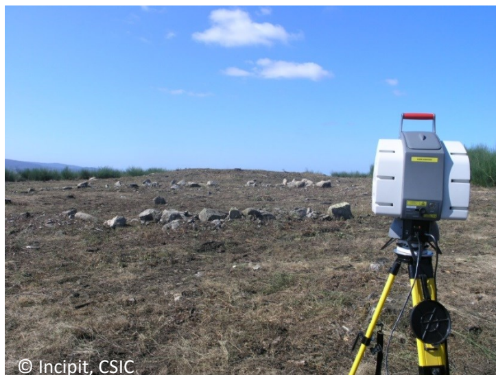
Figura 23. Registro 3D en 2008 del círculo lítico por medio de Escáner Láser Terrestre (TLS; Leica HDS3000).
