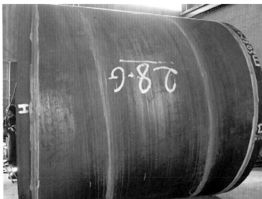
Fig. 11. El CENIM participa en los trabajos de verificación y certificación de la calidad de las uniones soldadas en tuberías de gran diámetro para el transporte de agua.
