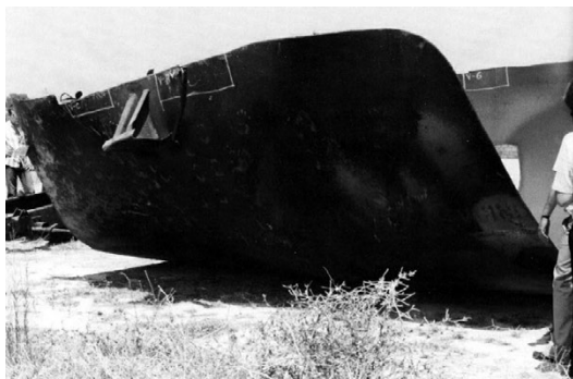
Fig. 6. Fragmentos de la cisterna para gases licuados que ocasionó el accidente del camping de Los Alfaques.
