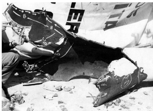
Fig. 8. Fragmentos de un depósito para almacenamiento de hidrógeno a presión que explotó en la factoría de la Sociedad Española del Oxígeno en la carretera de Villaverde (Madrid).
