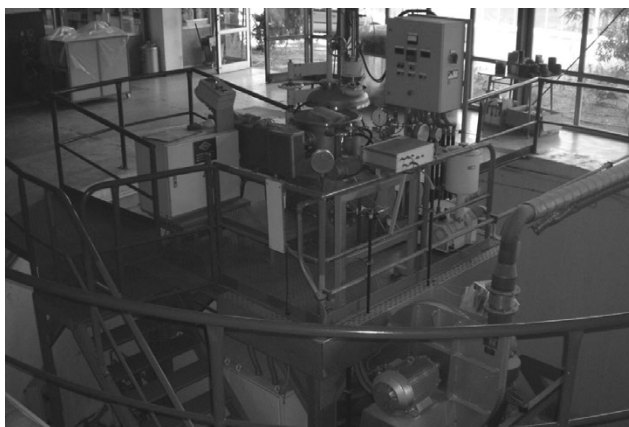
Atomizador del Departamento de Metalurgia Física instalado en la nave de Radiología Industrial.
