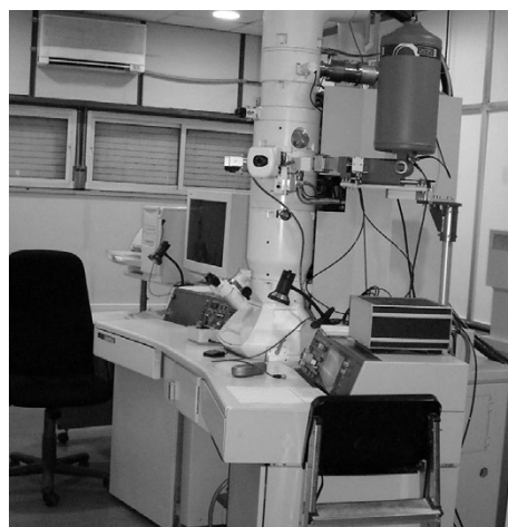
Microscopio electrónico de transmisión (MET) analítico de 200 keV.
