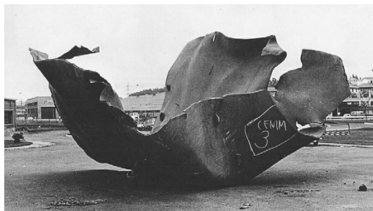
Fig. 2. Fragmento de un calderín acumulador de vapor tras su explosión en la factoría de ENSIDESA en Avilés (Asturias).
