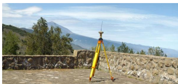
Figura 3. Toma de datos para el inicio y cierre de los perfiles altimétricos
