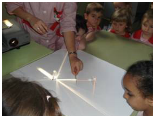
Imagen 7. La luz roja no se descompone tras pasar por un segundo prisma.
