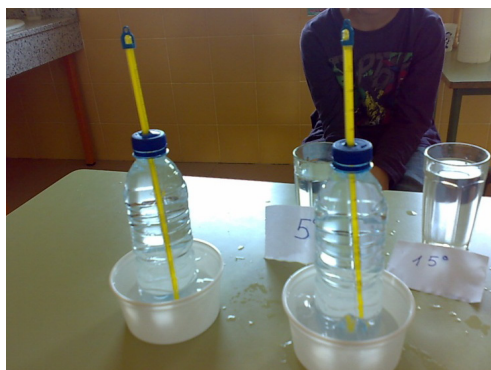
Imagen 3. Lectura de la temperatura en botellas estancas enfriándose.
