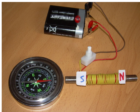
Imagen 5. Detección de polos en un electroimán.
