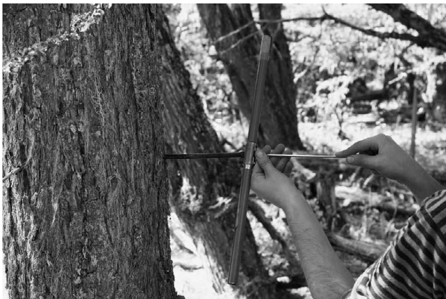
Figura 174. Extracción de muestras para dendrocronología.
