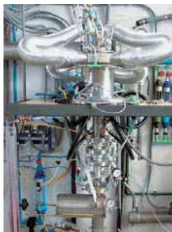
Reactor de flujo para el análisis de los procesos de la combustión de sólidos pulverizados, a la izquierda, y bajo estas líneas, turbina de combustión del Instituto de Investigación en Tecnologías de la Combustión, CSIC-Diputación General de Aragón-Universidad de Zaragoza (Archivo IITC)
