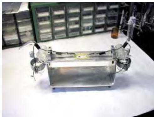
Instrumental del departamento de Química Física de Macromoléculas Biológicas (Izquierda) células de calorímetros. (Derecha) célula de microelectroforesis construida en el Instituto de Química Física del CSIC (IQFR)
