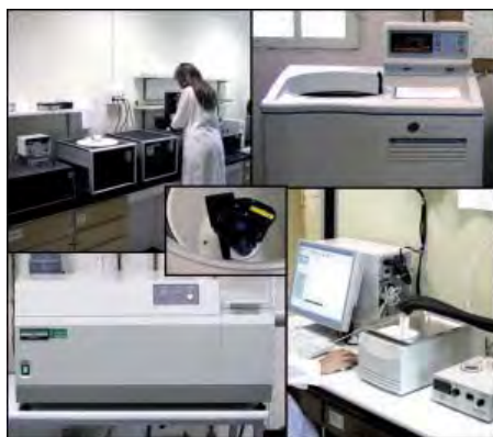
(Izquierda) instrumental del departamento de Química Física de Macromoléculas Biológicas del Instituto de Química Física del CSIC. De izquierda a derecha y de arriba abajo: microcalorímetros, ultracentrífuga analítica, espectropolarímetro y calorímetro diferencial de barrido. (Derecha) balanza Langmuir construida en el instituto (IQFR)
