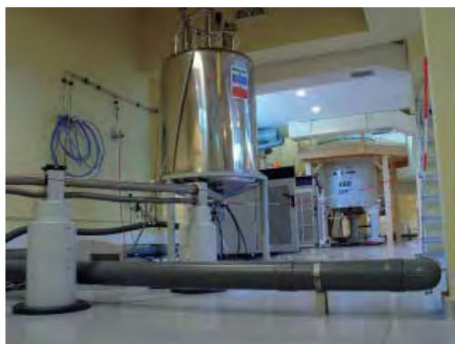
(Izquierda) espectrómetros RMN de alto campo, en primer plano, y Bruker AV-600, al fondo, del Instituto de Química Física del CSIC (IQFR). (Derecha) Modelo de formación de un cross-link entre un oligonucleótido platinando y el ADN
