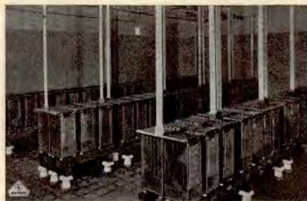
Fig. 4. Batería de acumuladores para experimentación.
