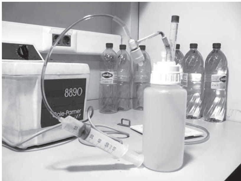
Figura 2. Botella usada en la campaña de intercalibración Malaspina en mayo de 2010. Tras realizar una depresión de 50 ml con la jeringa, se aplican ultrasonidos; a los 40 segundos ya habrán pasado a la jeringa unos 40 o 50 ml de agua (generando el vacío correspondiente en la botella), por lo que se cierra la llave amarilla y continúa el tratamiento de ultrasonidos hasta un total de 5 minutos, de modo que en la botella queda una depresión que da lugar a que los gases disueltos se acumulen en la parte superior (donde se encuentra un vial perforable que permite su posterior recuperación). El proceso de desgasificación se acelera con el tratamiento de ultrasonidos.
