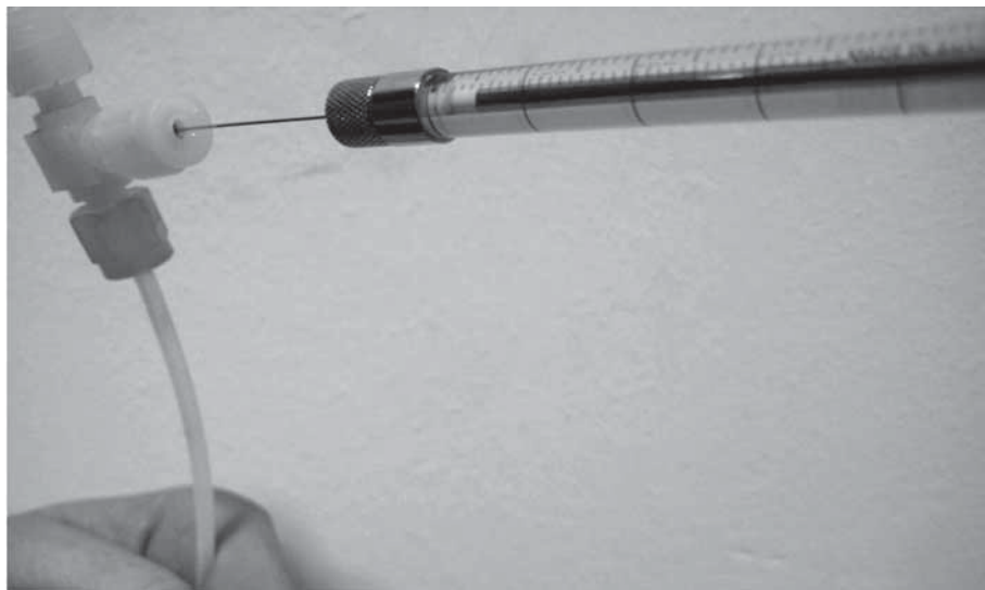
Figura 4. Pinchando con la aguja para patrón ( gas-tight ) en la corriente de He + DMS proveniente del horno de permeación. Se pincha a través de un septum , tratando de no dañar el interior de los tubos ni el septum mismo.
