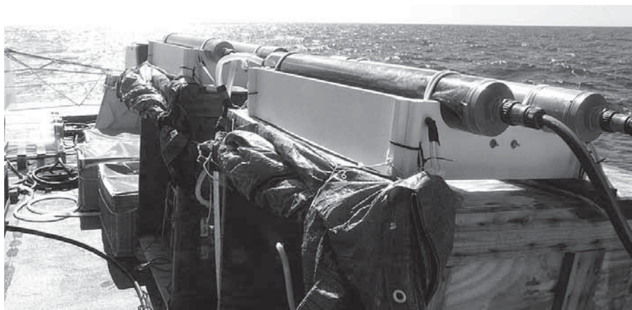
Figura 1. Las muestras de cada profundidad se incuban en cubierta durante 24 horas ajustando, mediante filtros y sistemas de recirculación de agua a través de refrigeradores, las condiciones de luz y temperatura de cada profundidad.
