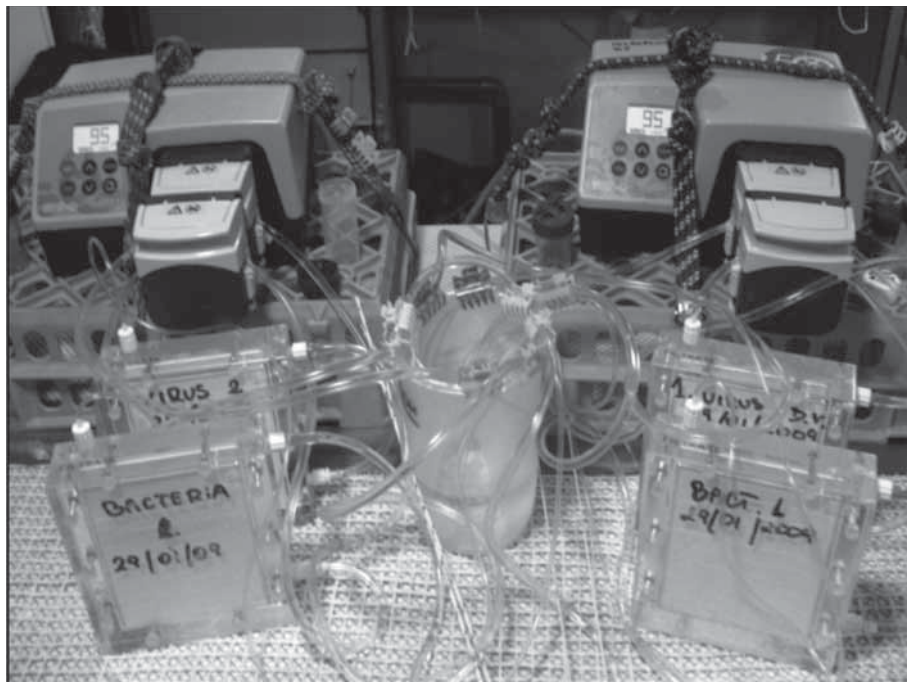
Figura 1. Bombas peristálticas con cartuchos de VIVAFLOW de 0.2 \mu\text{m} y 30 KDa.
