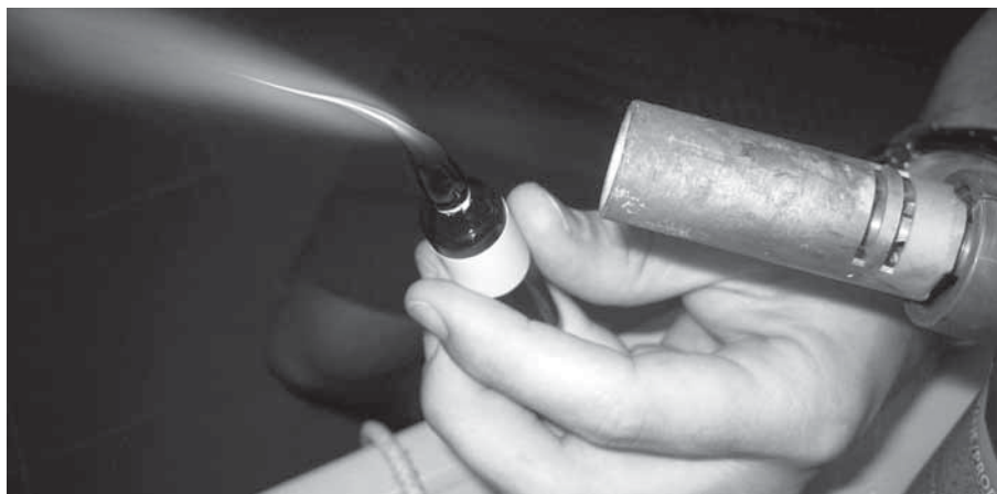
Figura 2. Detalle del sellado de las ampollas.
