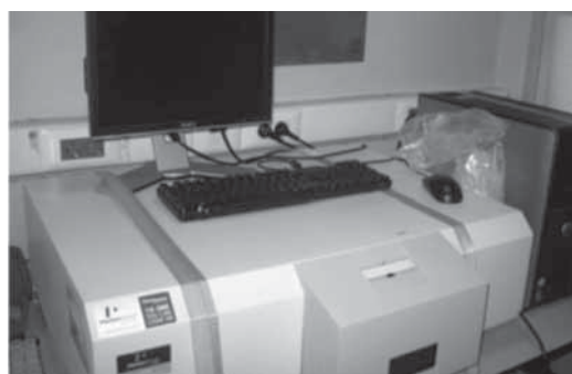
Foto 5. Espectrofluorímetro para lecturas de muestras de amonio.
