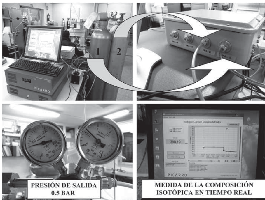
Figura 5. Conexiones estándar de calibración del sistema.
