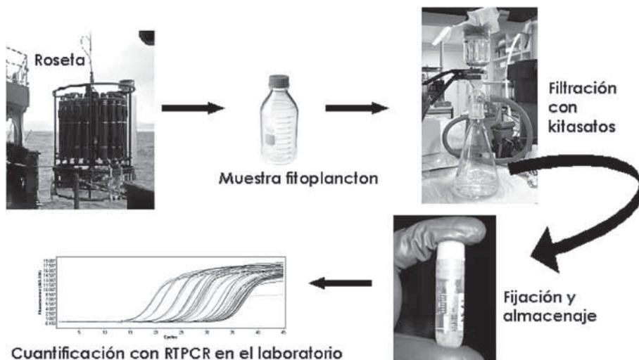
Figura 1. Esquema del sistema de muestreo de fitoplancton en la zona fótica.
