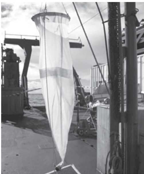
Foto 1. Red WP-2 (100 \mu m ) utilizada en la recogida de muestras.
