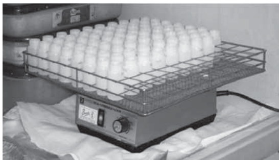
Figura 2. Agitador orbital usado en la eliminación de ^{14}\text{C} de los filtrados, que se realiza en el interior de la campana de extracción de gases
