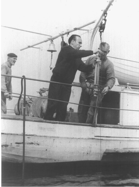
San Feliú y Canales en 1962 tomando muestras de agua con una botella Nansen a bordo de la embarcación Nika en el delta del Ebro.
