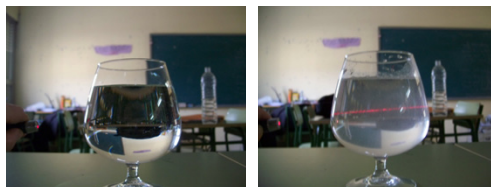
Imagen 2. Trayectoria del rayo láser en el agua.
