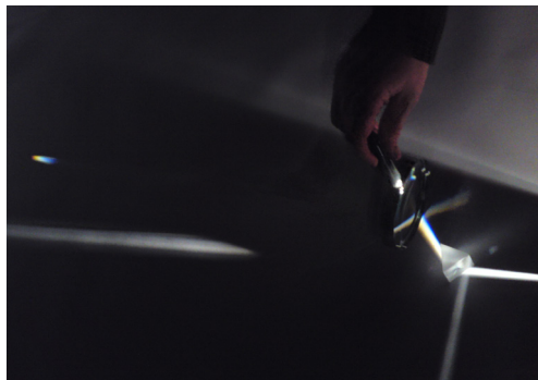
Imagen 9. Obtención del espectro y posterior composición de la luz blanca.
