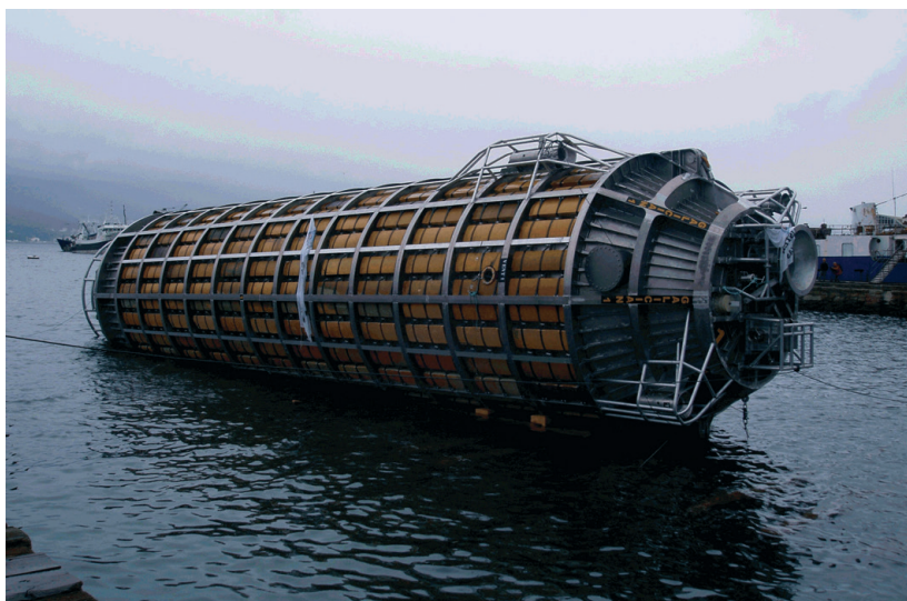
Figura 6. Lanzadera rígida. Capacidad 350 m 3 ; longitud 23; diámetro 5 m.
