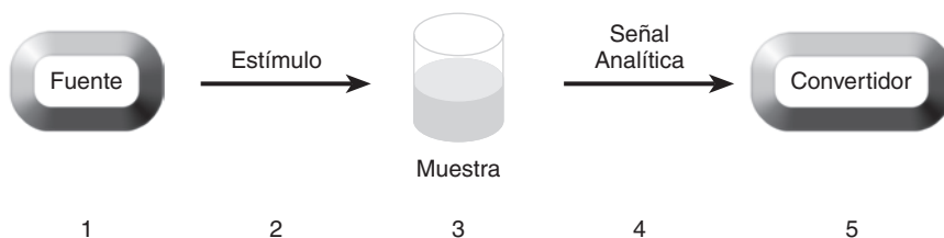
Figura 1.1. Componentes de un instrumento de análisis.
