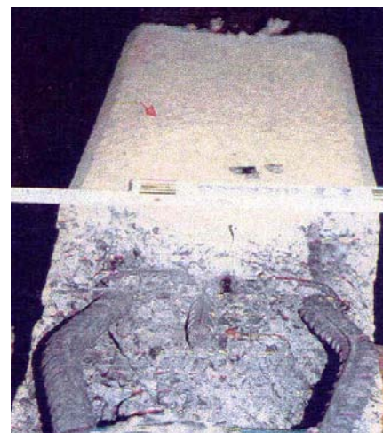
Fig. 7. Efecto de la temperatura sobre la adherencia armadura hormigón. Dcha., deformación de la armadura causada por el fuego en un pilar de hormigón.
