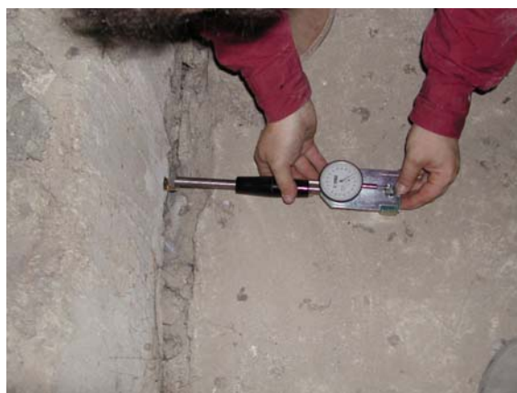
b) Medidas con extensómetro
