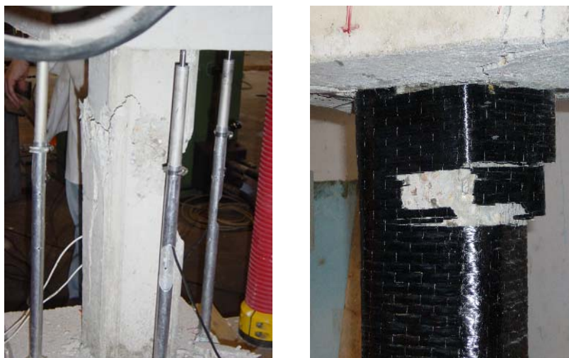
Figura 3.6 Rotura de las probetas nº 1 y nº 2
