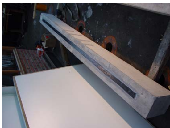
Figura 14. Sellado de fisuras
