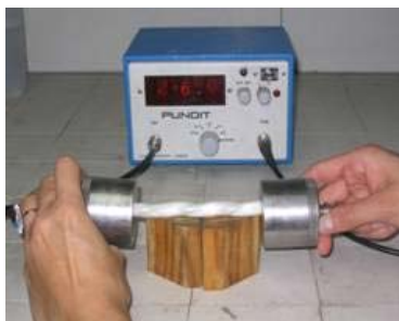
Fig. 3.1 Medida del modulo elástico con el PUNDIT
