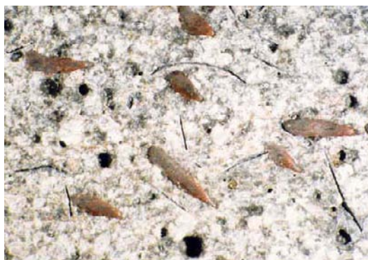
Fig.10. Efecto de la presencia de fibras en la respuesta frente al fuego del hormigón. Fibras metálicas oxidadas y huecos dejados por las fibras de polipropileno al fundirse.
