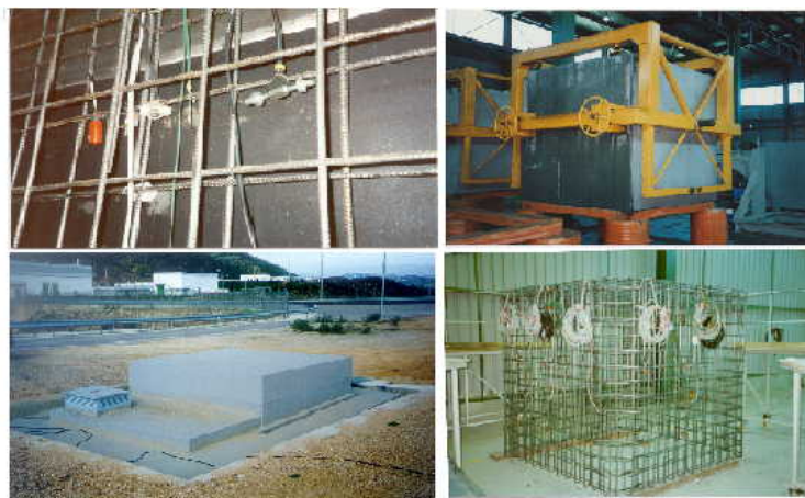
Figura 10 Contenedor piloto instrumentado en las instalaciones de El Cabril
