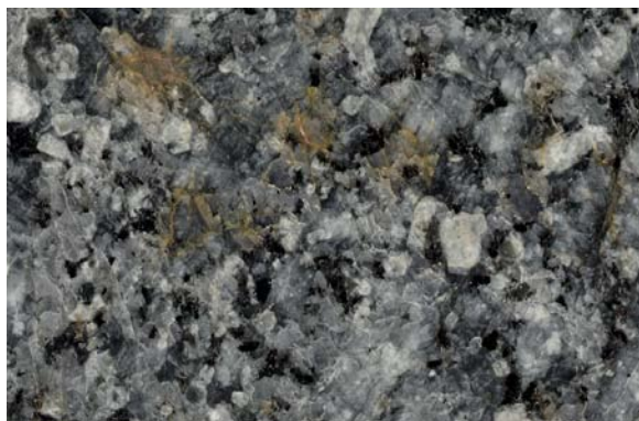
Foto.-8. Manchas de oxidación, en un granito de color azul.
