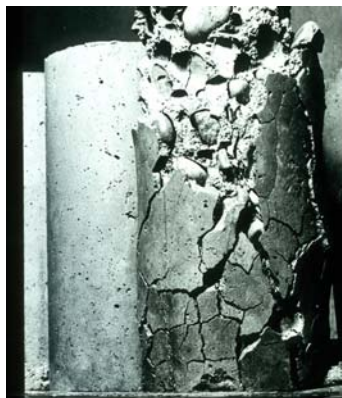
Figura 4.- Lesión producida por el yeso presente en un árido.
