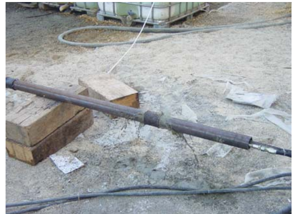
d) Inyección de lechada de prueba en el exterior
