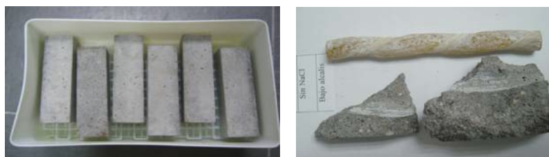
Fig. 3.2 Probetas de mortero con barra embebida
