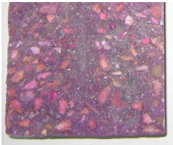
Fotografía 1. Probeta sin carbonatar
