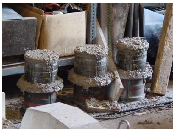
Figura 3. Fabricación de probetas cilíndricas 15 x 30
