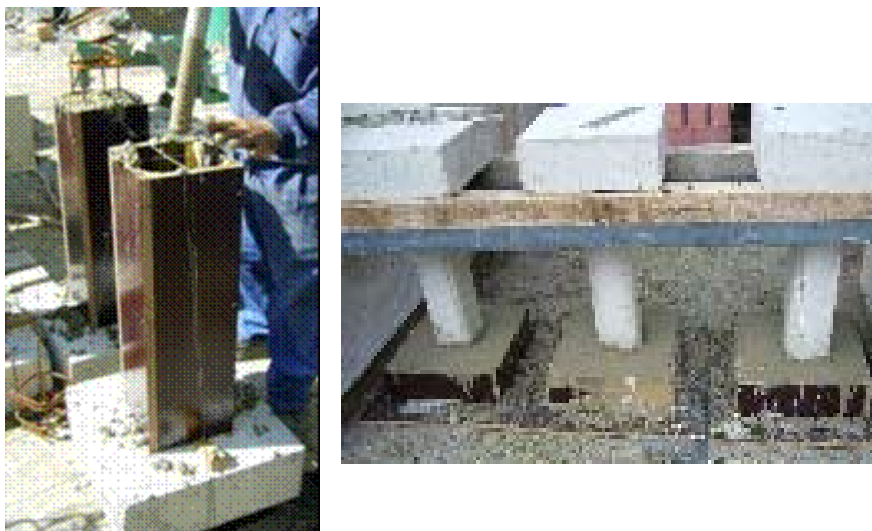
Figura 3.2 Fabricación de las probetas de hormigón
