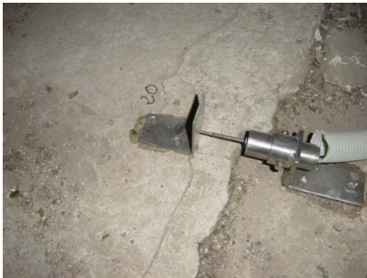
c) Fisurómetro
