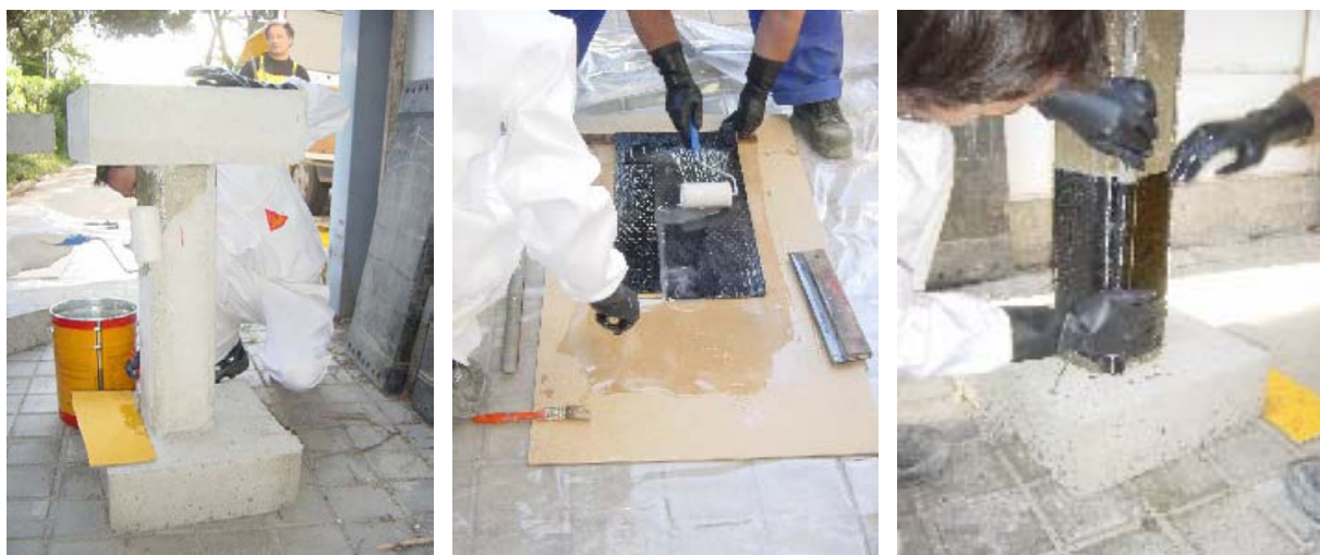
Figura 3.3 Refuerzo de las probetas
