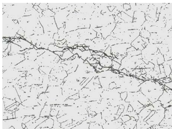
Fotografía 10.5. Ataque oxálico (× 180 ) Corrosión bajo tensiones.
