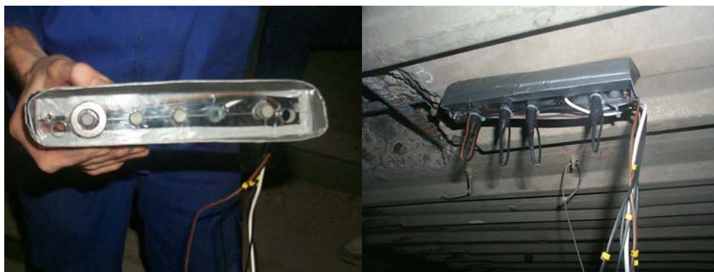
Figura 11 Colocación de sensores en superficie para la monitorización en continuo de estructuras ya existentes.
