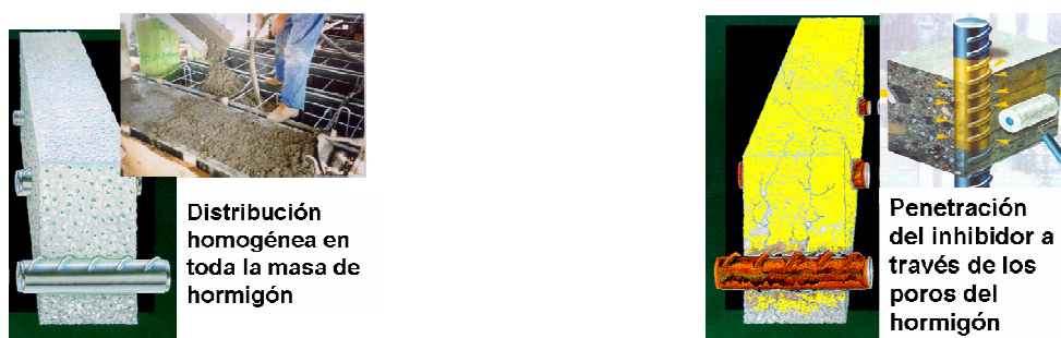
Fig. 6. Distintas posibilidades de aplicación de los inhibidores de corrosión al hormigón.
