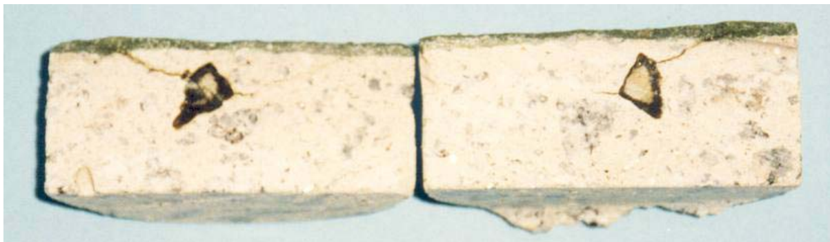
Figura 2.1. Corte de un testigo de hormigón con un árido alterado.
