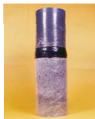
Fotografía 4. Probeta con piscina sellada sobre ella.
