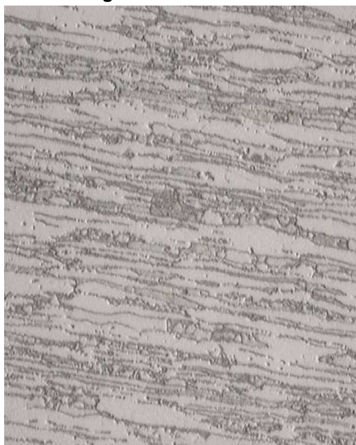
Fotografía 3.3.1. Acero dúplex 1.4362 Ataque V2A ( × 1000 aumentos) Sección longitudinal
