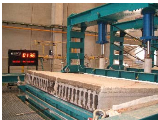
Fig. 2.5 Sistema hidráulico de carga en horno horizontal
