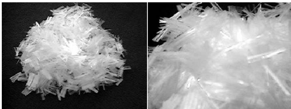
Figura 5.1. Fibra de polipropileno (M. Barreda et al. ).
