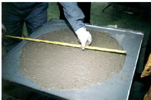
Figura 6. Izq.: Ensayo del escurrimiento. Dcha.: Ensayo del embudo en V.
