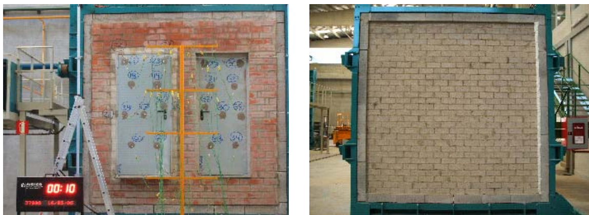
Fig. 3.1 Muestras ensayadas con dimensiones reales y con 3×3 m, respectivamente
