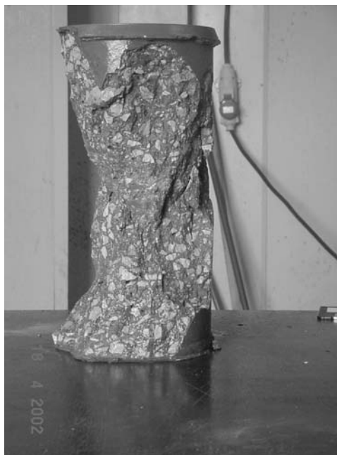
Figura 8. Probeta cilíndrica 16 x 32 cm después del ensayo a compresión
