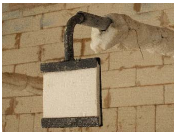
Fig. 2.3 Termopar de placa
