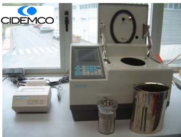
FOTOGRAFÍA 4: Bomba calorimétrica, equipamiento de acuerdo a UNE EN ISO 1716:2002
