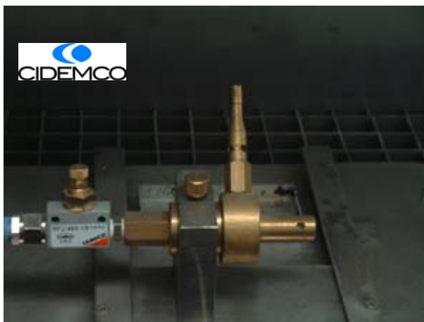
FOTOGRAFIA 5: Aspecto fuente de ignición y muestras sometidas a ensayo de acuerdo a UNE EN ISO 11925-2:2002
