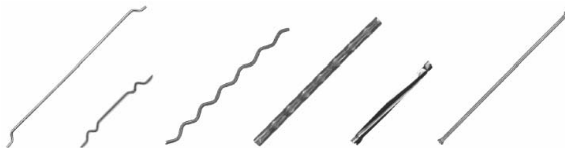
Figura 4.1. Diversos tipos de fibra de acero (B. Weiler, C. Grosse).
