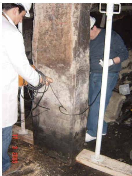
Fig. 3. Medida directa de la velocidad de ultrasonidos. Influencia del nivel de daño. Tamaño y proximidad de la fisura (13).
