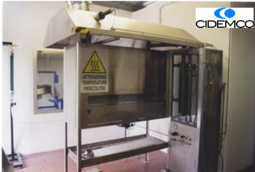
FOTOGRAFÍA 2: Aspecto panel radiante
