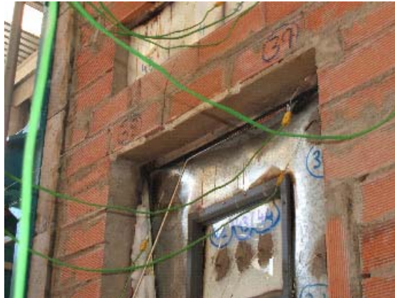
Fig. 4.3 Aplicación de la galga de 6 mm
