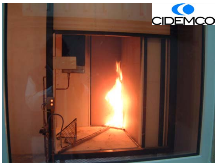
FOTOGRAFÍA 1: Muestra sometida a ensayo según UNE EN 13823:2002
