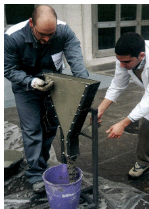
Figura 6. Izq.: Ensayo del escurrimiento. Dcha.: Ensayo del embudo en V.
