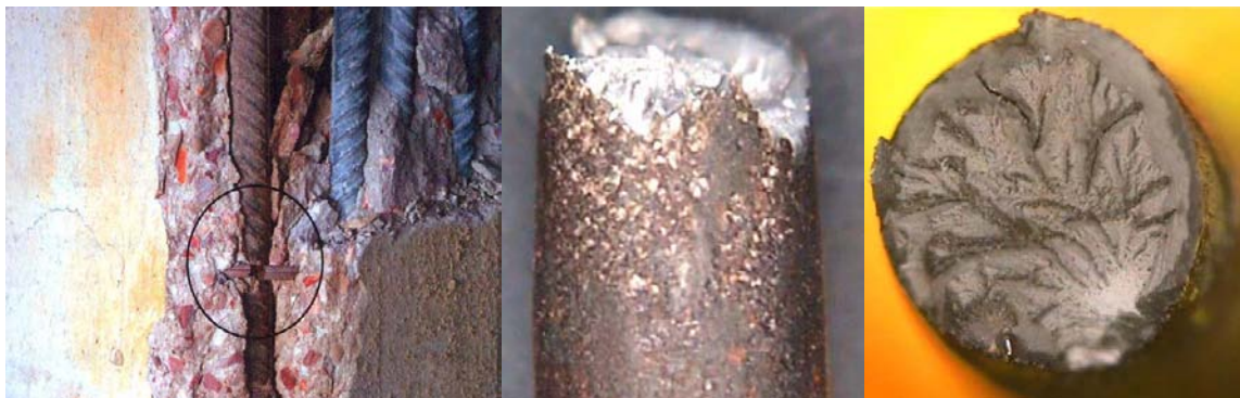
Fig. 13. Aspecto de las armaduras afectadas por el fuego.
