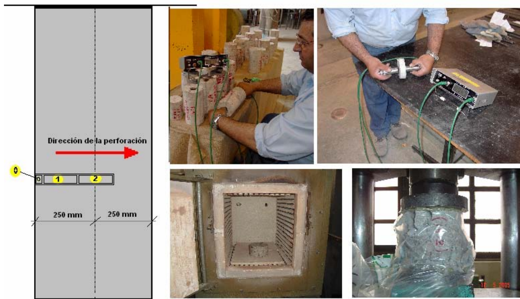
Fig. 14 Ensayos de hormigón: medidas de ultrasonidos, tratamiento térmico y ensayo a compresión
