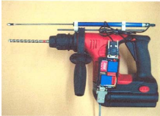
Fig. 6. Aspecto del taladro y medidas en hormigones afectados por el calor.
