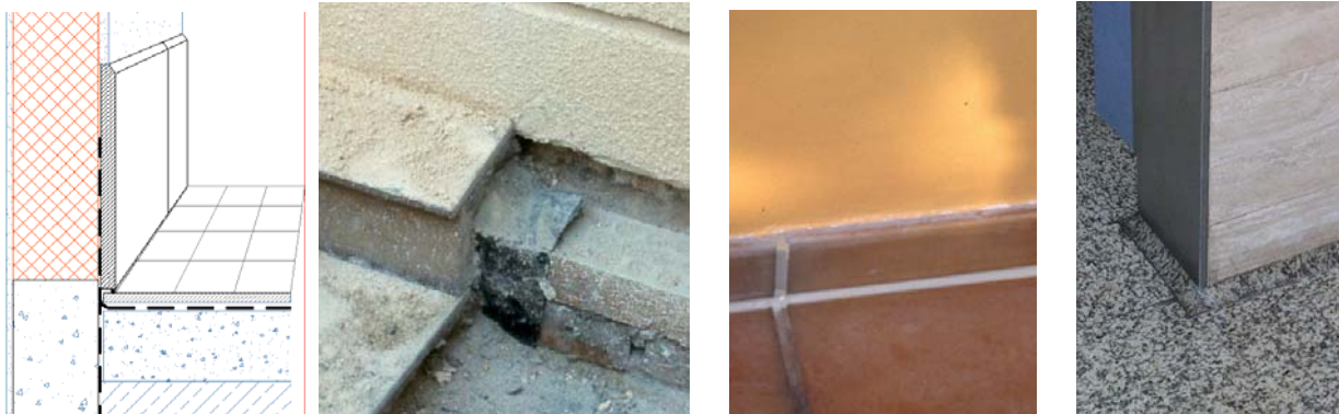
Fig. 18 - Prevención de filtración en zócalo se fachada; consideraciones generales
