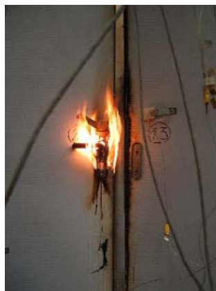
Fig. 4.4 Aparición de llamas sostenidas sobre la muestra
