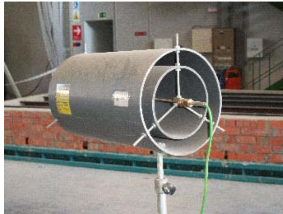
Fig. 2.7 Termopar de temperatura ambiente
