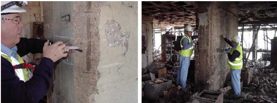
Fig. 12 Determinaciones en obra: medida de recubrimientos y reconocimiento ultrasónico
