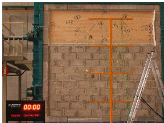
Fig. 3.3 Muestra de madera sobre obra soporte rígida de alta densidad
