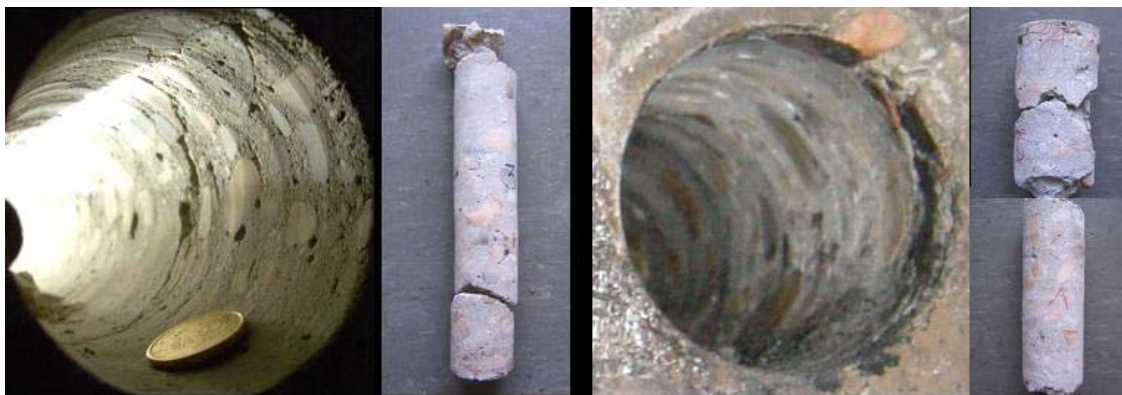
Fig. 1. Testigos y daños en el interior del hormigón de una estructura expuesta a fuego no aireado de larga duración, 48 horas.
