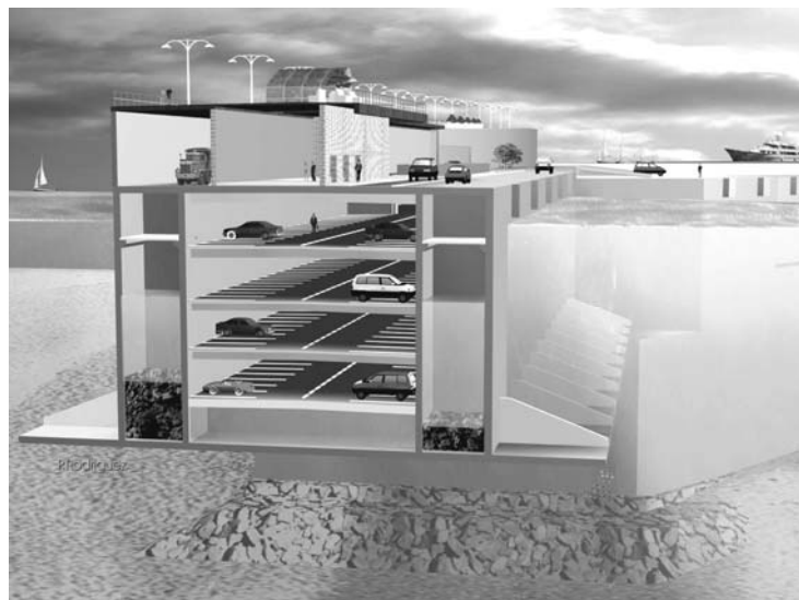
Figura 4. Sección transversal del dique flotante
