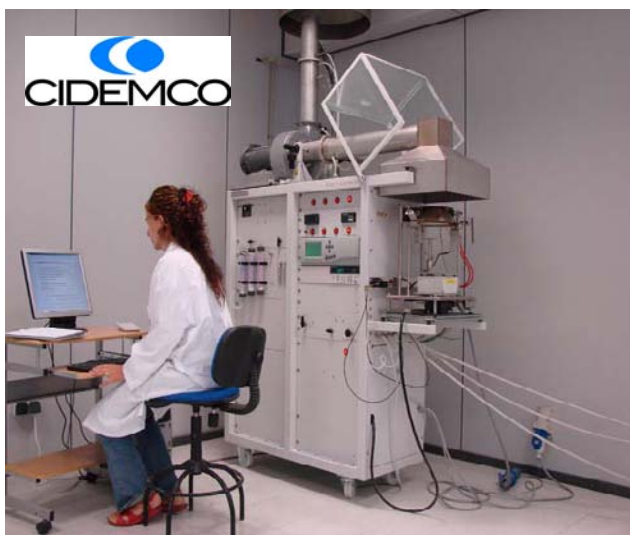
Fotografía 8: Cono calorimétrico, equipamiento de alto valor científico, empleado principalmente en I+D+i.
