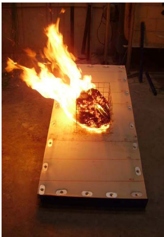
FOTOGRAFÍA 6: Aspecto muestra sometida a ensayo bajo UNE ENV 1187:2003 , método pavesa en llamas.
