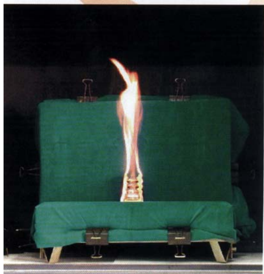
FOTOGRAFÍA 7: Aspecto muestra sometida a ensayo bajo norma UNE EN 1021-21994
