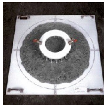
Figura 7. Izq.: Ensayo de la caja-L. Dcha.: Ensayo del escurrimiento con anillo.
