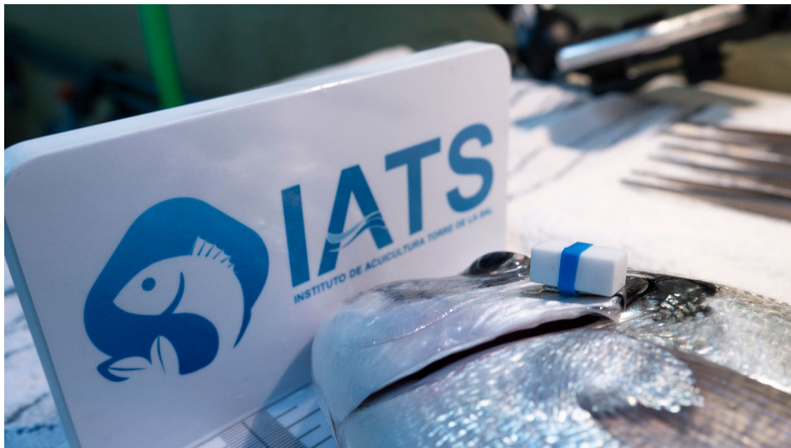
FishBit Biologger, implantado externamente en el opérculo para el registro preciso y no invasivo de la frecuencia respiratoria y de la actividad física de peces en condiciones experimentales. / GRUPO DE NUTRIGENÓMICA Y BIOLOGÍA INTEGRATIVA DE PECES (IATS, CSIC)
