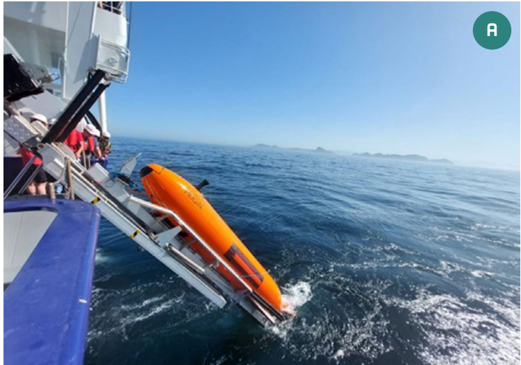
Figura 13 A) AUV Hugin 6000, recientemente adquirido por el CSIC. Es un robot submarino que opera de forma autónoma bajo el agua y puede alcanzar los 6000 metros de profundidad. B) Ejemplo de imagen del fondo marino proporcionada por este equipo. La resolución es de 0,5 metros. IMÁGENES CEDIDAS POR IRENE P. DÍEZ
