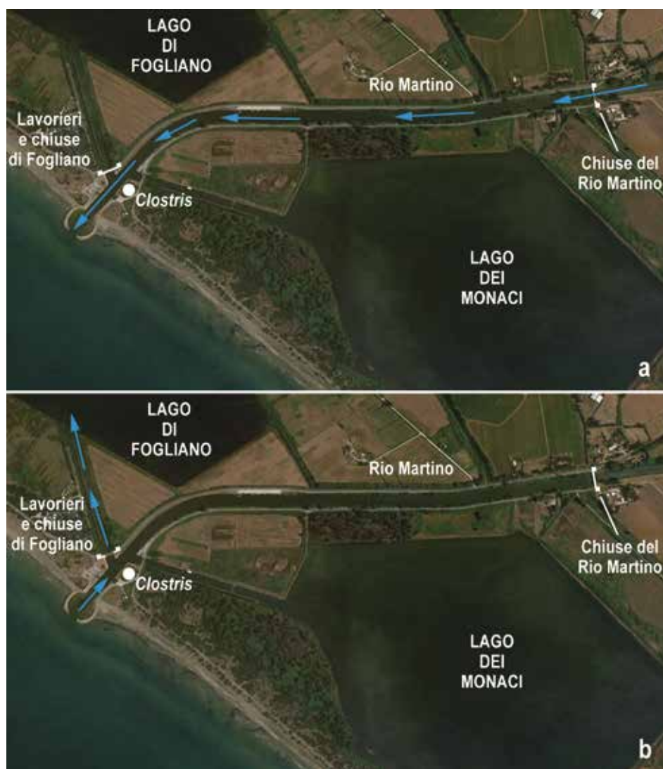
Figura 7. Funzionamento degli sbarramenti degli argini tra Rio Martino e Fogliano (base immagine satellitare GoogleEarth 2022, elaborazione dell'autore).
