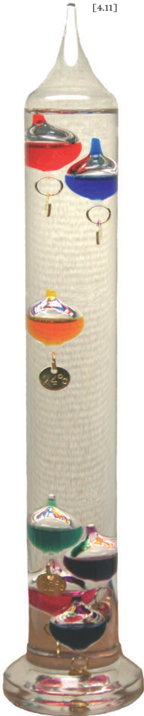
[4.11] Réplica del termómetro de Galileo (1592).
