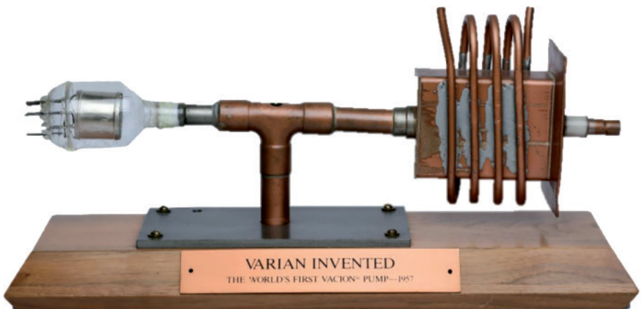
[7.20] (a) Primera bomba desarrollada. (b) Su esquema, donde se aprecia el ánodo en forma de panel cúbico. (c) Esquema que figura en la patente. (d) Figura que representa el primer prototipo comercial.
