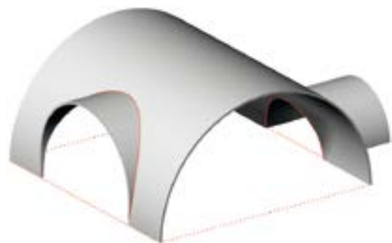
Figura 1.20. Modelo teórico de bóveda de cañón con lunetos. Las curvas intersección entre cilindros de distinto radio son curvas cuárticas. Por los autores.
