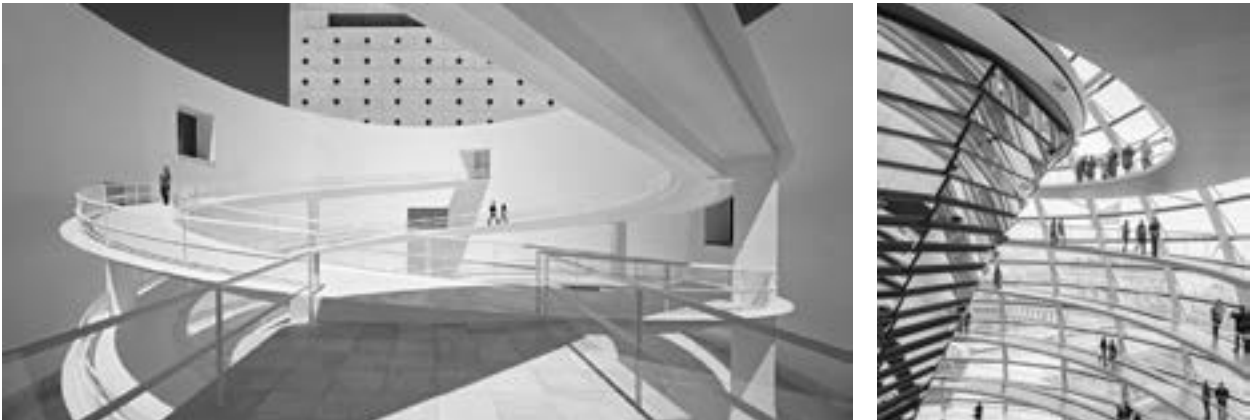
Figura 1.38. Izquierda: Museo de la Memoria de Andalucía, Granada (Campo Baeza, 2010). Las rampas son helicoides cilíndricos. Derecha: Cúpula del Reichstag, Norman Foster, 1999 (imagen de Francesco Luca Labianca, licencia Unsplash, https://unsplash.com/es/fotos/s6GxA0FDDBE ). Las rampas interiores son helicoides que se apoyan en hélices esféricas.
