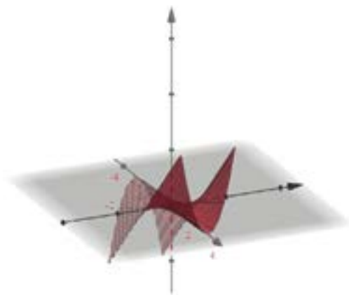
Figura 1.41. Izquierda: conoide. Derecha: marquesina de la Unesco, París, Pier Luigi Nervi y Marcel Breuer, 1958. (Martín Fuentes, 2018). Esta superficie reglada une un arco y una curva superior muy tendida.
