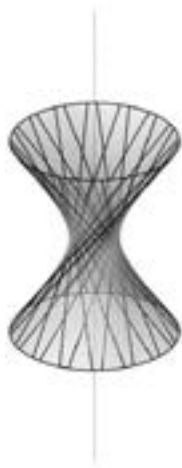
Figura 1.32. Izquierda: hiperboloide hiperbólico. Derecha: tribuna del Hipódromo de la Zarzuela, Madrid, Eduardo Torroja, 1935. Esta obra incorpora los hiperboloides hiperbólicos en las láminas voladas de la cubierta, mientras que las gradas se apoyan en bóvedas tóricas (Torroja, E., 1962b) (Moragues et al., 2015) (Martínez, I., Castillo, 2018).
