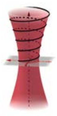
Figura 1.33. Izquierda: depósito de agua en Fedala, Marruecos, Eduardo Torroja, 1956. La estructura consta de dos hiperboloides hiperbólicos unidos por su círculo de garganta y bóvedas anulares de directriz parabólica (Torroja, E., 1962a). Centro: mirador Treetop, Copenhague, Denmark, EFFEKT Studio, 2018. Este elemento es un hiperboloide hiperbólico representado por sus generatrices y directrices. En su interior se incluye una rampa helicoidal que se adapta a la forma de la hipérbola (Caliò, Marchetti, 2019). Derecha: Hélices contenidas en un hiperboloide de una hoja.
