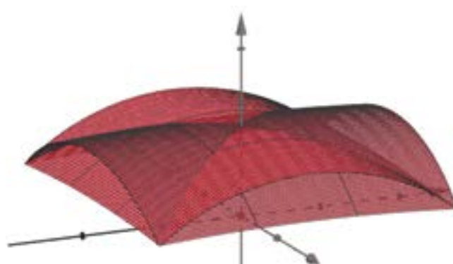
Figura 1.45. Izquierda: Windward City Foodland, Keneohe, Hawaii, UU. EE., J. Joedicke, 1958 (Joedicke, 1964). La cubierta es una bóveda por arista bitórica, cubre una planta cuadrada de 39 metros de lado y su espesor varía desde 8 cm en el centro hasta los 18 cm. Derecha: representación del edificio toroidal en Keneohe. Representación Geogebra.
