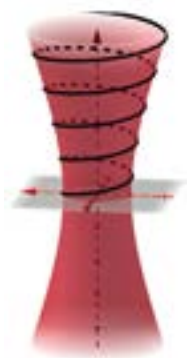
Figura 1.33. Izquierda: depósito de agua en Fedala, Marruecos, Eduardo Torroja, 1956. La estructura consta de dos hiperboloides hiperbólicos unidos por su círculo de garganta y bóvedas anulares de directriz parabólica (Torroja, E., 1962a). Centro: mirador Treetop, Copenhague, Denmark, EFFEKT Studio, 2018. Este elemento es un hiperboloide hiperbólico representado por sus generatrices y directrices. En su interior se incluye una rampa helicoidal que se adapta a la forma de la hipérbola (Caliò, Marchetti, 2019). Derecha: Hélices contenidas en un hiperboloide de una hoja.
