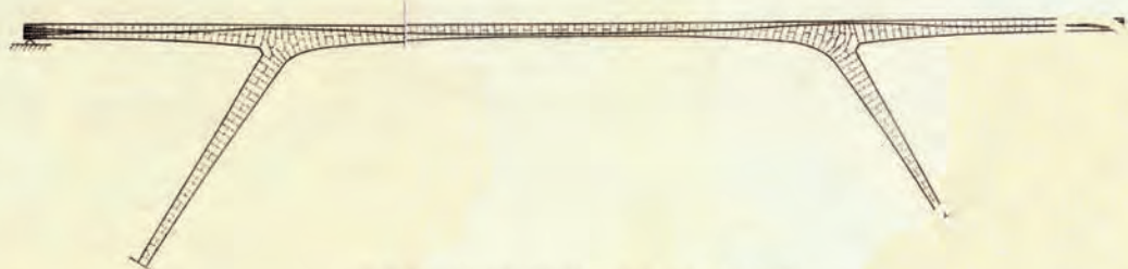
Fig. 2. Disposición general de cables de pretensado, bloques de anclaje y apoyos.
