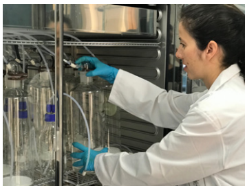
Reactores para ensayos de biodegradación en medio compost/ suelo. / UNIDAD DE BIODEGRADABILIDAD Y COMPOSTABILIDAD, PTI SUSPLAST, IATA
