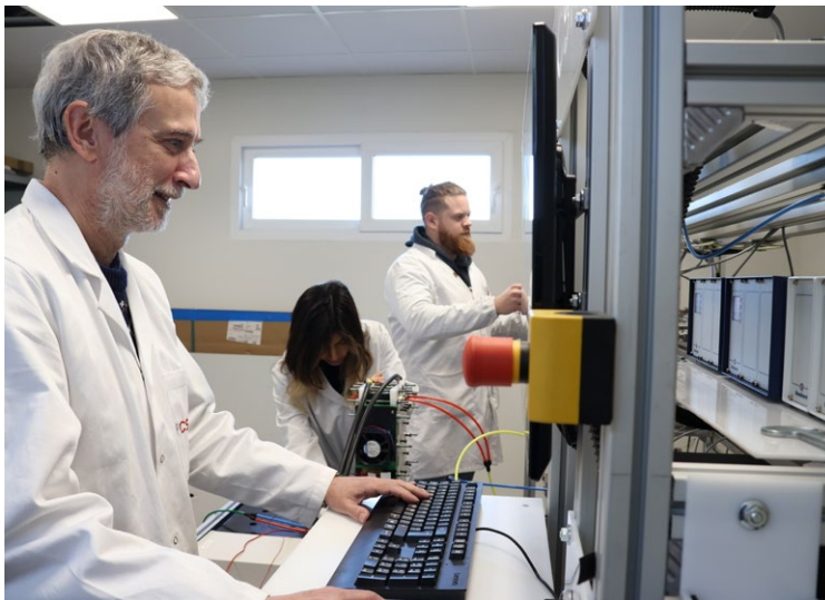
Banco de pruebas para pilas de hidrógeno. / ICB
