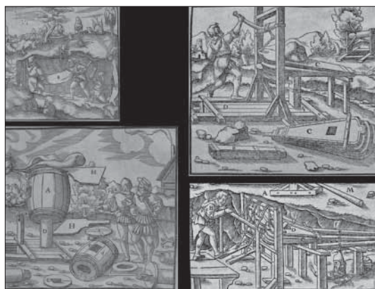
Fig. 11. Vari sistemi di ventilazione delle gallerie esposti in Agricola, De re metallica .
