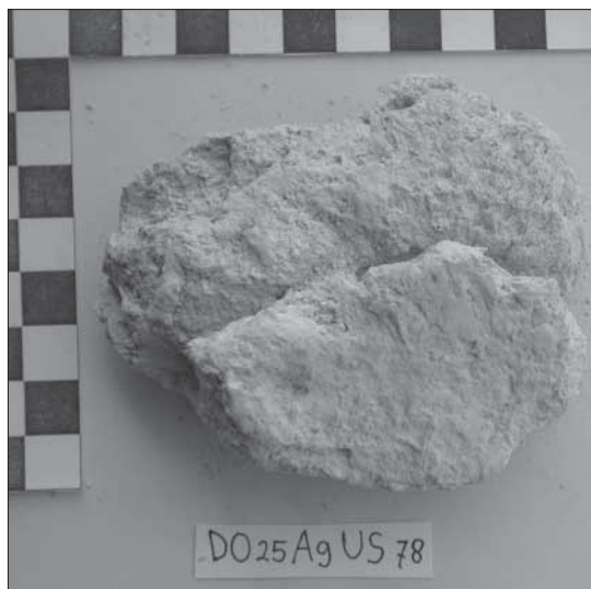
Fig. 19b. Idem : frammento di pisé rivestito di intonaco.
