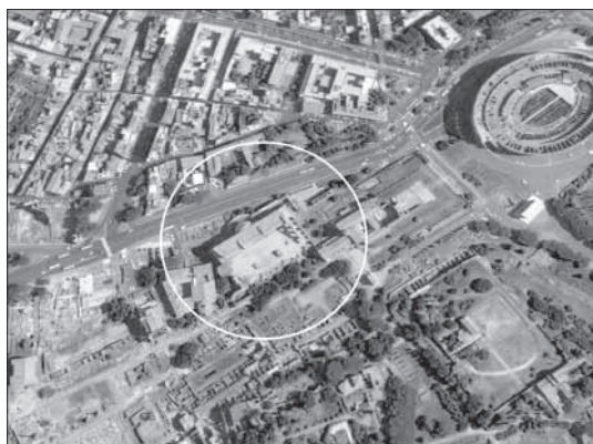
Fig. 2. Roma, Basilica di Massenzio, costruzione: 306-312. Altezza: 39 m. Superficie di base: 6800 mq; superficie praticabile: 9800 mq.
