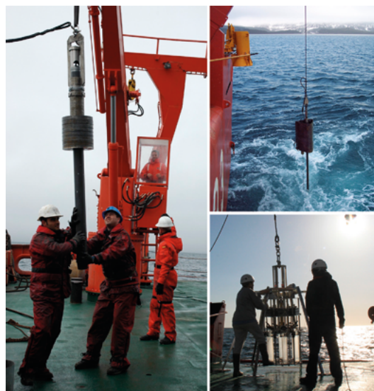
Figura 1. Sistemes de recuperació de sediments marins profunds: el gravity corer (a l'esquerra i a dalt a la dreta) i el multicorer (a baix a la dreta). Imatges: Unitat de Tecnologia Marina, UTM-CSIC.
