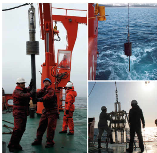
Figura 1. Sistemas de recuperación de sedimentos marinos profundos: el gravity corer (a la izquierda y arriba a la derecha) y el multicorer (abajo a la derecha). Imágenes: Unitat de Tecnologia Marina, UTM-CSIC.
