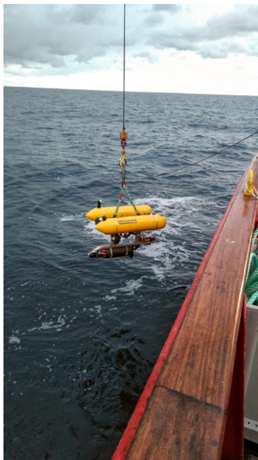
Figura 1. El AUV Girona 500 utilizado para rastrear cigalas ( Nephrops norvegicus ) a 400 m de profundidad en el noroeste del mar Mediterráneo.
