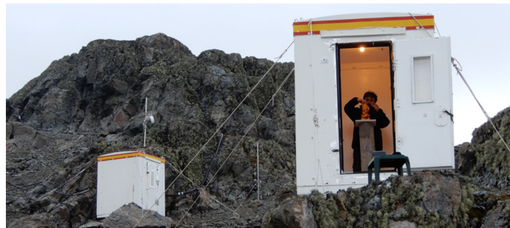
Realizando medidas absolutas en el observatorio geomagnético de Isla Livingston (Islas Shetland del Sur, Antártida). (Autor: J.M. Torta)
