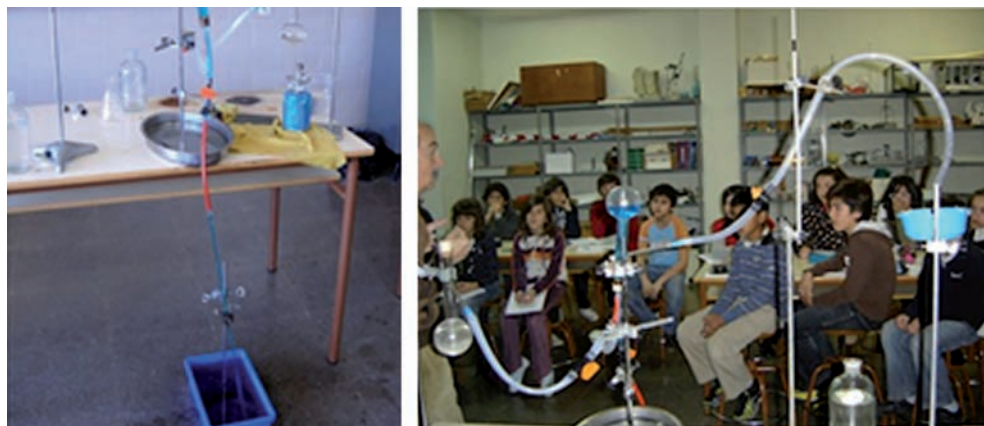
Imagen 6. Construcción de la máquina de Savery y su funcionamiento en el Colegio de Corella.
