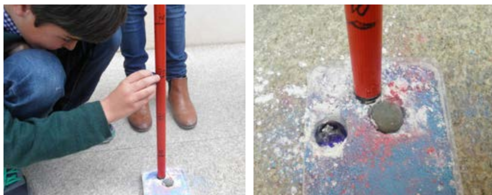
Imagen 4. Ensayo de deformación de objetos, con diferente masa, que caen de alturas distintas.
