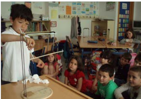
Imagen 2. Alumno utilizando un versorium, fabricado en el aula, para descubrir los tipos de carga (positiva y negativa) y las fuerzas eléctricas (atracción y repulsión).
