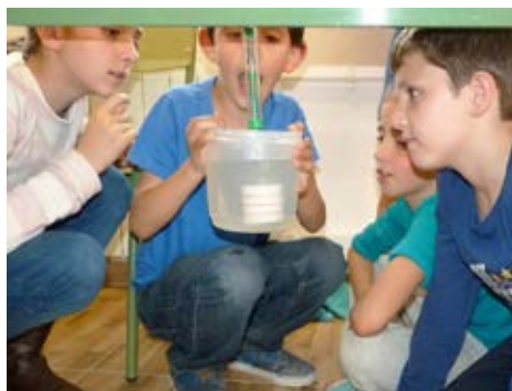
Imagen 11. Alumnos midiendo con un dinamómetro el peso aparente (peso-empuje) de un objeto sumergido.
