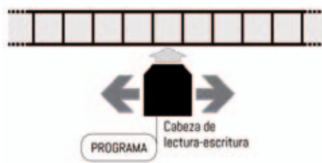
Imagen 4. Esquema de la máquina de Turing.
