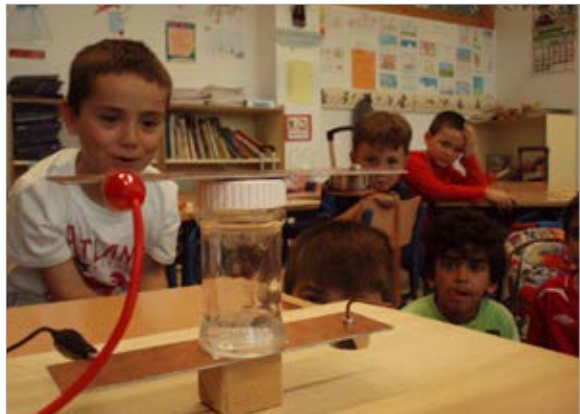
Imagen 6. Nuestro motor eléctrico consta de un imán de neodimio, un alambre conductor enrollado a él en un extremo y una conexión a unas pilas.
