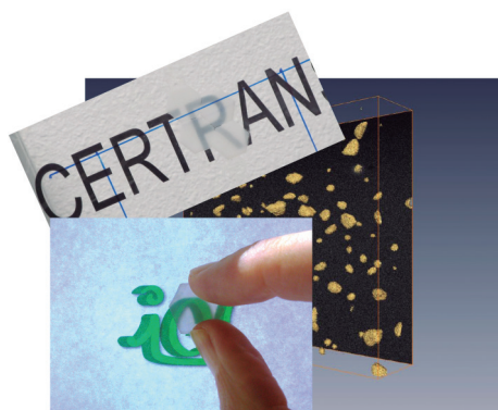
Figura 4. Prototipos cerámicos de alúminas transparentes mediante procesamiento convencional sin presión.
