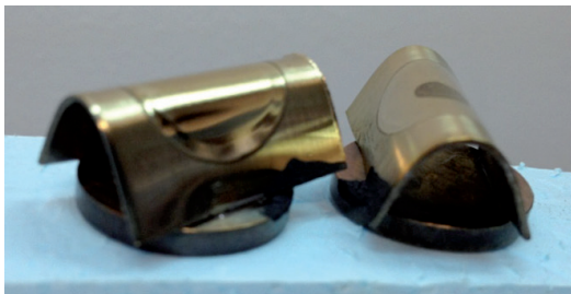
Figura 10. ZnO rods crecidos hidrotérmicamente sobre sustrato de acero electropulido previamente semillado por deposición electroforética (18).
