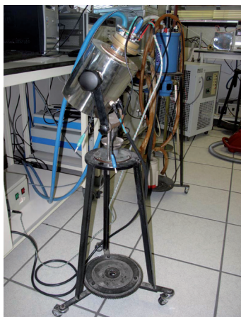
Figura 6. Equipo para determinar la impedancia compleja en materiales electrocerámicos.
