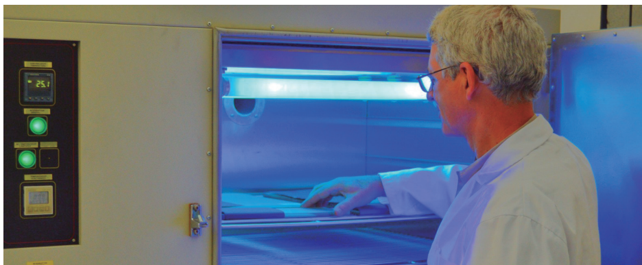
Figura 3. Ensayo de resistencia a la radiación solar de baldosas cerámicas.
