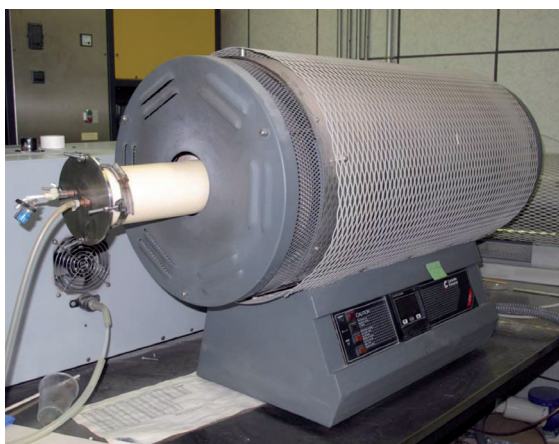
Figura 7. Horno para tratamientos térmicos en atmósfera controlada.
