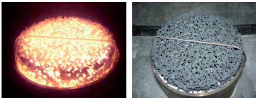
Figura 7. Imagen de un quemador de SiC: con llama en modo radiante y una vez ensayado.
